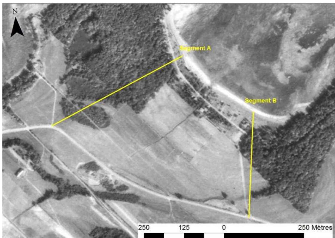
Figure 16 : Distance entre la plage et un point-repère fixe de l'année 1960, secteur du ROM de Saint-Vallier, Saint-Michel-de-Bellechasse, Québec.
